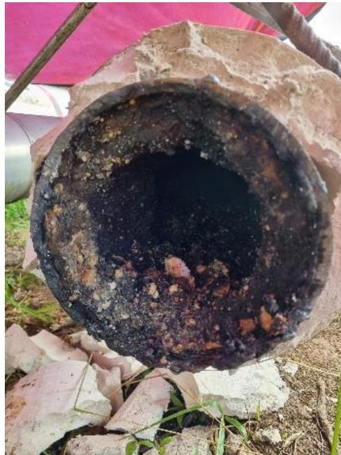
**Gambar 2. Silica Scale Pada Pipa**
