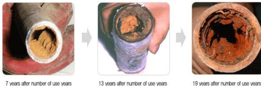
**Gambar 3. Ilustrasi Pertumbuhan Silica Scale Pada Pipa**
